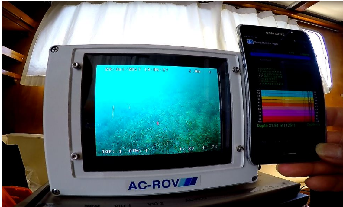
Φωτογραφία 3: Το καταδυόμενο R.O.V. βρίσκεται σε βάθος 21.51 μ., όπως διακρίνεται στην οθόνη του κινητού το οποίο είναι συνδεδεμένο μέσω bluetooth με το βυθόμετρο. Στην οθόνη του ROV είναι εμφανής η ύπαρξη πυκνής Ποσειδωνίας στο σημείο.
